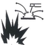
在焊接区域应消除火灾隐患，如果不可行，应加以覆盖以防止焊接火星引起火灾。牢记焊接产生的火星和灼热的材料容易通过细小的裂缝和开口而扩及附近区域。避免在液压管线处进行焊接，将灭火器放置于易及之处。在不焊接时，确保焊钳回路中的任何元件不与工件或大地接触。无意接触也可能引起过热并产生火灾。
