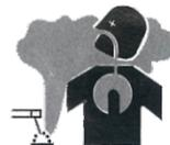
焊接可能产生对健康有害的烟雾和气体，应避免吸入。在焊接时，使头部远离烟雾。采用充分的通风或排气设施使烟雾和气体远离呼吸区域。电弧焊接所用的保护气体可能排入空气，引起人身伤害或窒息。为了确保吸入的空气安全，务必采用充分的通风设施，尤其在封闭的区域更应如此。
