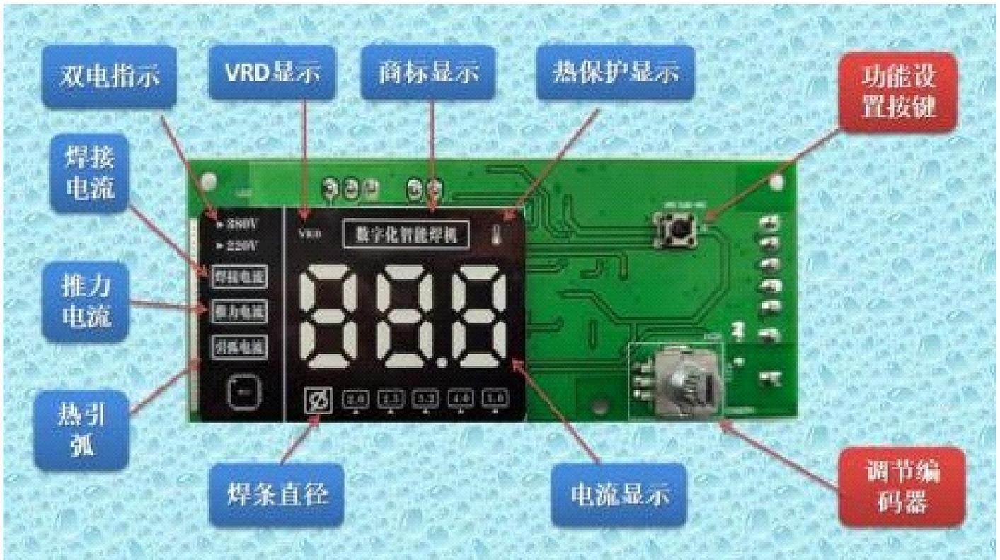
1、焊机正常上电后，默认显示的是焊接电流，此时，旋转编码器进行焊接电流调节。短按编码器可以进行焊接电流的快速调节。
